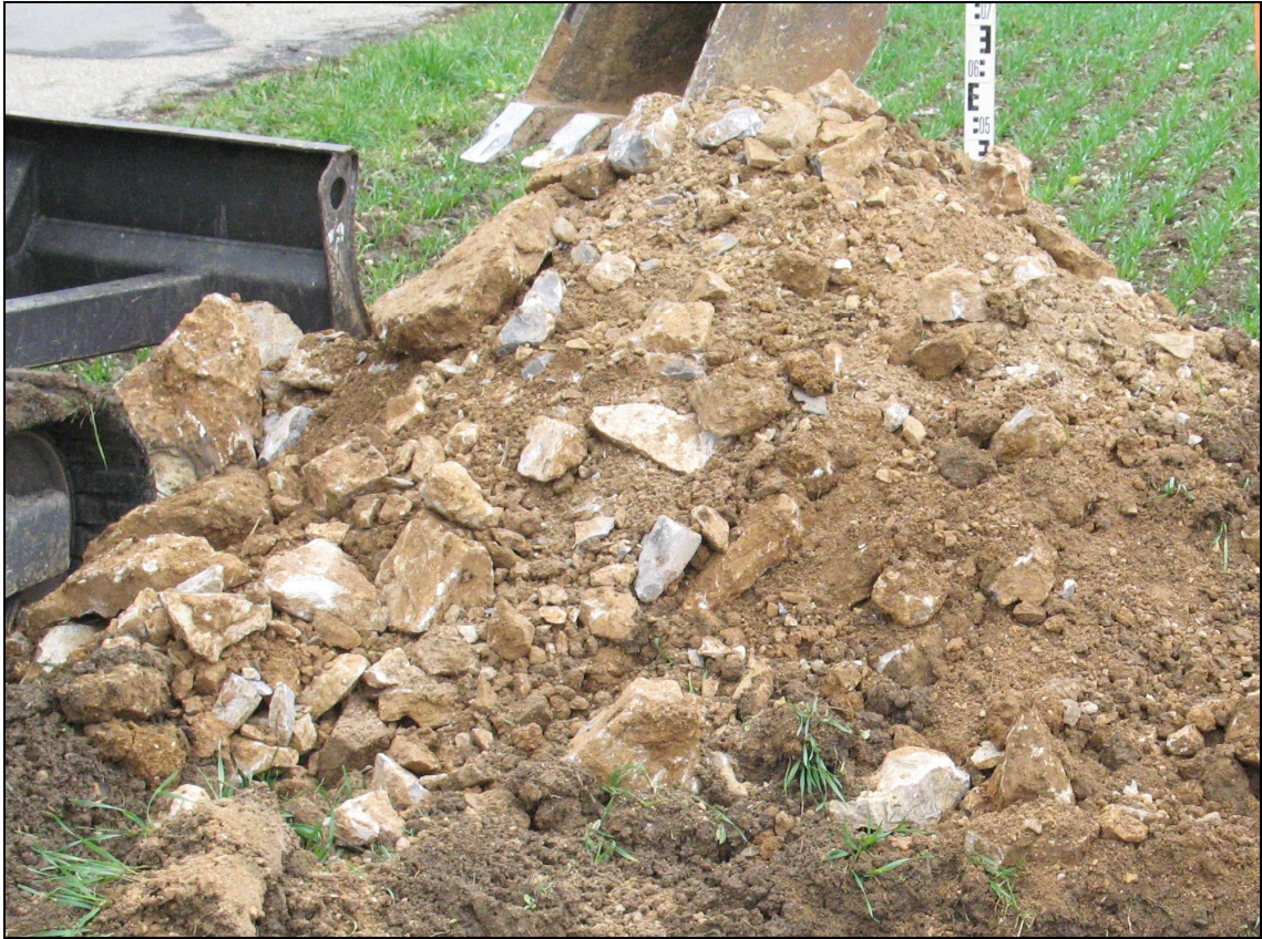
Foto 2: Stark steiniger Aushub des Sickerschurf S 1, Schurftiefe 1,5 m (Foto: HTR, 06.11.2014)
