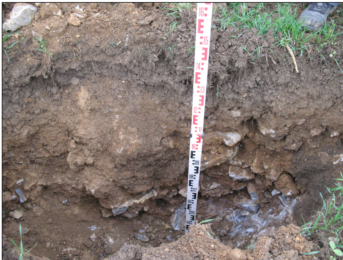
Foto 1: Sickerschurf S 1: Ab ca. 0,40 - 0,50 m u. GOK stehen steinige, nur mäßig verlehnte Böden bzw. verwitterte Felsböden des Mittleren Muschelkalks an (Foto: HTR, 06.11.2014)
